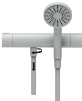
Schrauben Sie den Duschschlauch von der Armatur ab.
