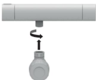
Montieren Sie den AQUATIMER mit dem Knopf nach vorne an die Armatur.
